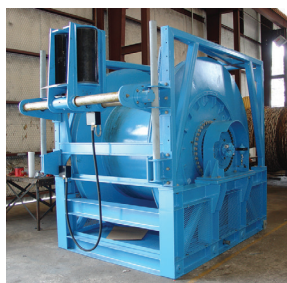
521 ROVリフトウインチ 2,500メートル 大型ROVウインチ
