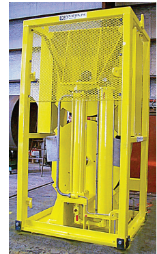
フライングシーブ動揺補償装置501 安全使用荷重9,000 kg 垂直補償範囲±2.75メートル シーブトレッド径1.2メートル
