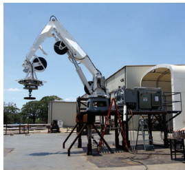
CTD動揺補償クレーン1075 安全使用荷重3,400 kg 垂直補償範囲±1.25メートル 船外リーチ5.5メートル
