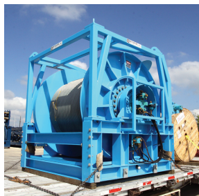
421 ROVウインチシステム 3,000メートル 中型ROVウインチ
