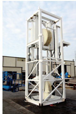
フライングシーブ動揺補償装置1160 安全使用荷重15,900 kg、垂直補償範囲±3.5メートル、シーブトレッド径1.2メートル
