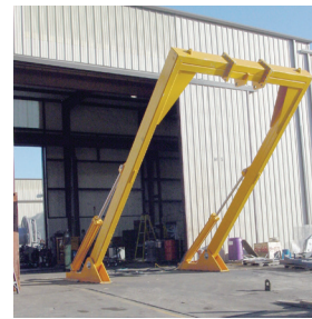
汎用Aフレーム474 ラフィング時定格荷重4.5トン 船外作業時定格荷重7.5トン
