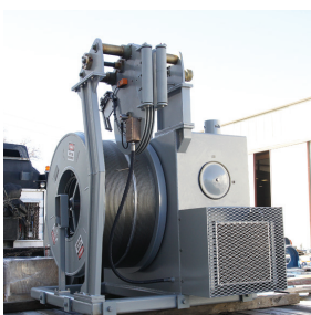
10030カンチレバーウインチ 30馬力 安全使用荷重（SWL） 840kg
