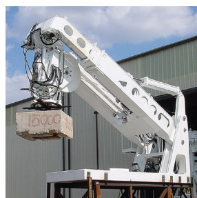
伸縮式投入・揚収システム1015 ラフィング時定格荷重13.5トン 船外作業時定格荷重22トン
