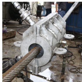
Tuff Coat M船舶用潤滑システム ワイヤーロープに取り付けられた Tuff Toolルブリケーター
