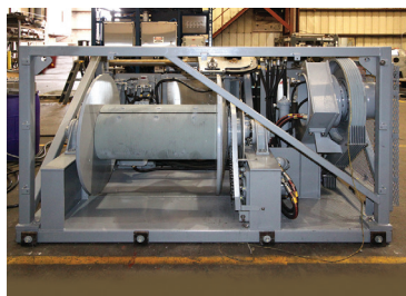
CTDトラクションウインチシステム 60～100馬力 安全使用荷重 1,814 kg ～ 4,173 kg
