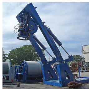
自立組立式Aフレーム966 ラフィング時定格荷重13.5トン 船外作業時定格荷重22トン
