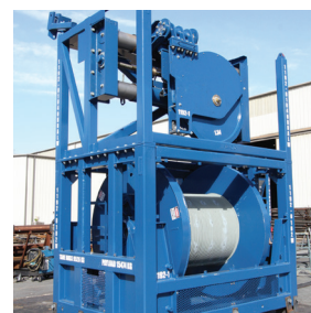
421 D3 ROVリフトウインチ 3,000メートル 大型ROVウインチ
