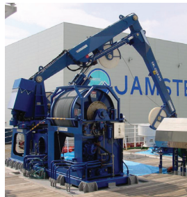
CTD動揺補償クレーン630 安全使用荷重1,800 kg 垂直補償範囲±1.25メートル 船外リーチ7.0メートル
