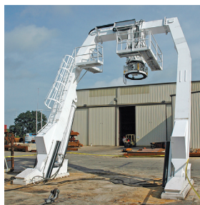
標準型Aフレーム952 ラフィング定格16トン 船外定格30トン
