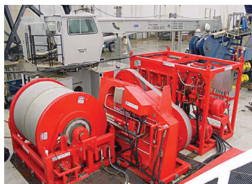
766深海曳航トラクションウインチシステム 200馬力 安全使用荷重 9,072 kg
