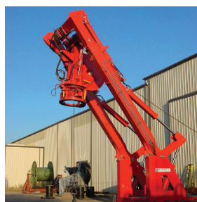
伸縮式投入・揚収システム7021 ラフィング時定格荷重10トン 船外作業時定格荷重20トン
